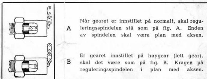
Her ser man regulerings-spindelen innskrudd i akslingsnøkkelen. Pass på at denne er helt innskrudd. De to punkter for innstilling av spindelen er også avmerket.
